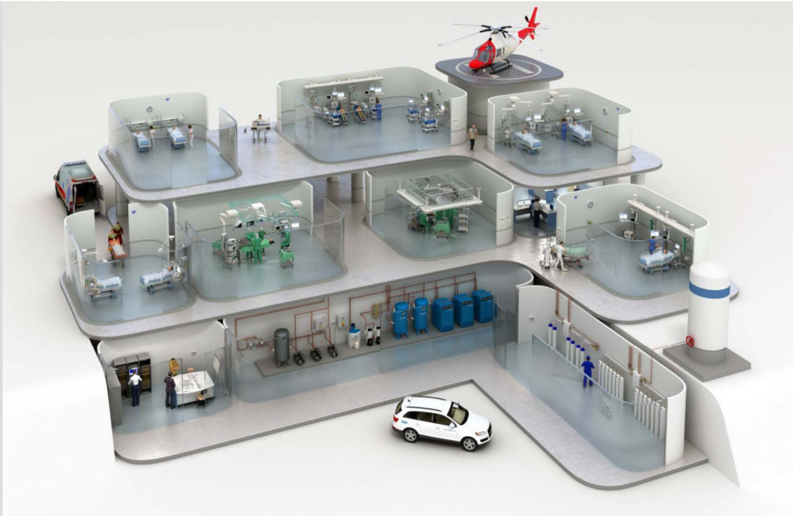
Typisches Beispiel einer Anlage für die medizinische Gasversorgung
